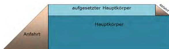
Abb. 5: Unterteilung des befüllten Silos in Grundkörper
